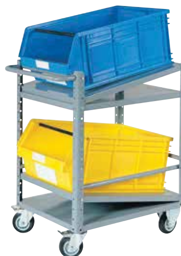
G Chariot à plans inclinés 2 roues pivotantes avec frein et 2 fixes. Plans inclinés réglables. Pour bacs de 88 litres (livrés sans étiquette).
