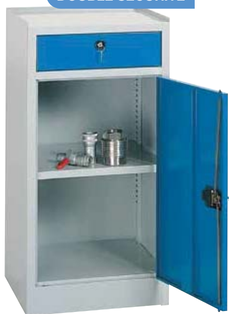
AT 55 1 tiroir individuel avec fermeture à clé et 1 tablette charge 40 kg. Rebord supérieur 3 côtés. Serrure avec fermeture 2 points. Dim. utiles tiroir : l. 390 x P. 370 x H. 88 mm Dimensions : H. 1000 x l. 500 x P. 500 mm ■ 33.4 300 662
